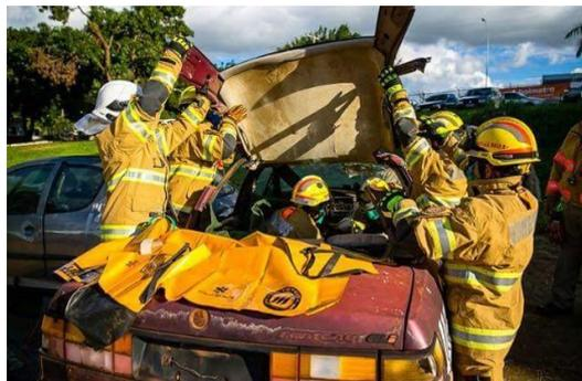
Figura 11 - Exemplo de criação de via de extração para retirada ângulo 0 de vítima sentada no banco do passageiro dianteiro
