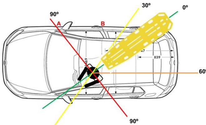
Figura 5 - Exemplo de ângulos de extração para vítima sentada de forma inclinada no banco do condutor
