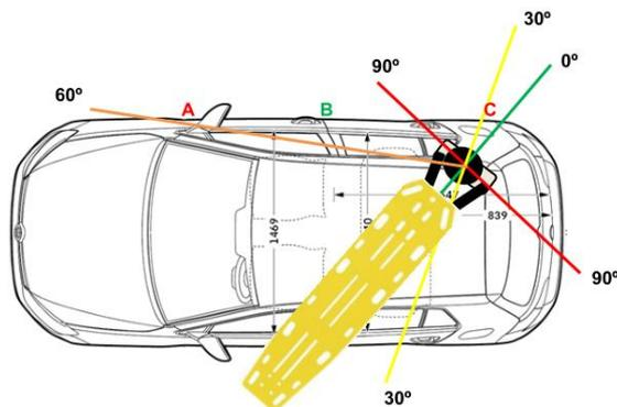
Figura 7 - Exemplo de ângulos de extração para vítima sentada no banco de passageiros traseiro e levemente inclinada
