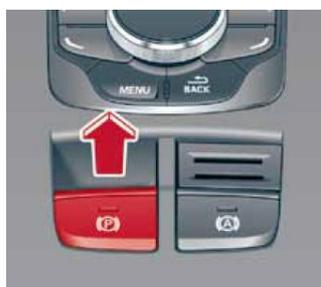
Figura 9 - Mecanismo de acionamento do freio eletrônico de estacionamento de veículo da Audi
