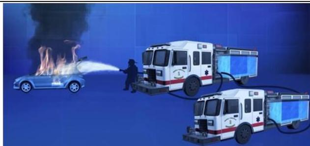
Figura 20 - Suprimento extra de água no combate a incêndio em um VE/VEH
