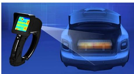
Figura 21 - Uso de câmera térmica no combate a incêndio em um VE/VEH
