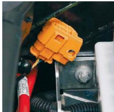
Figura 12 - Interruptor de serviço de veículo da BMW na posição OFF
