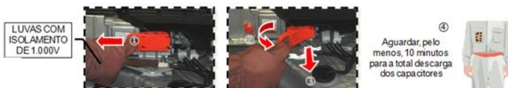
Figura 17 - Procedimento de retirada do plugue de serviço no Toyota Prius
