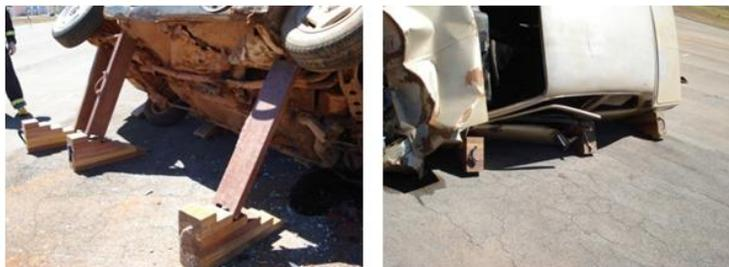
Figura 19 - Veículo lateralizado sobre uma das suas laterais e com indicativo de queda para o lado do assoalho
