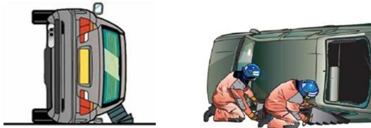
Figura 15 - Estabilização de um veículo que está apoiado sobre as laterais das rodas e uma das suas laterais, com colunas suspensas
