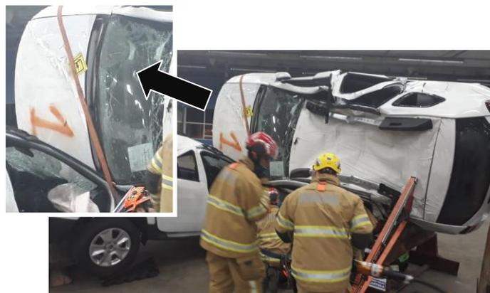
Figura 25 - Estabilização secundária, no caso, com uso de fita de carga com catraca para unir os veículos
