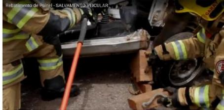
Figura 4 - Estabilização veicular progressiva durante rebatimento de painel
