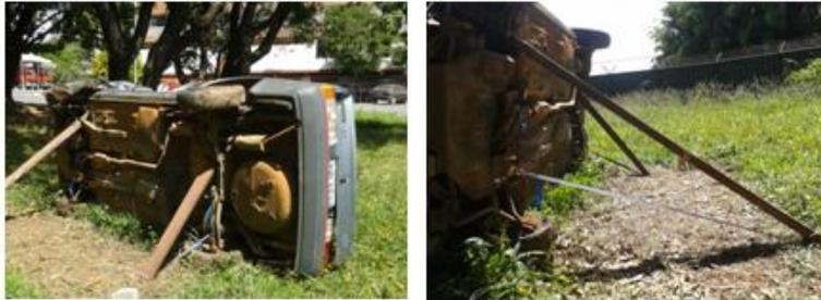
Figura 17 - Estabilização de veículo lateralizado com o uso de calços e escoras de madeira
