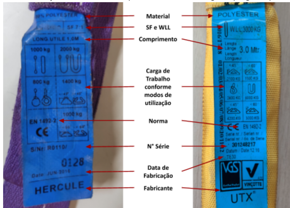
Figura 17 - Informações Técnicas nas etiquetas das Fitas de Carga empregadas pelo CBMDF
