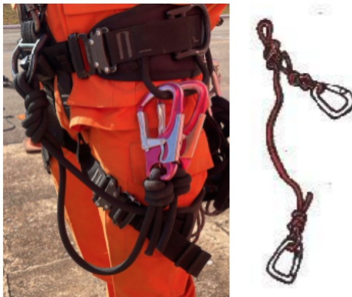
Figura 27 - Ilustração do Longe para Resgate: Corda Dinâmica EN 892
