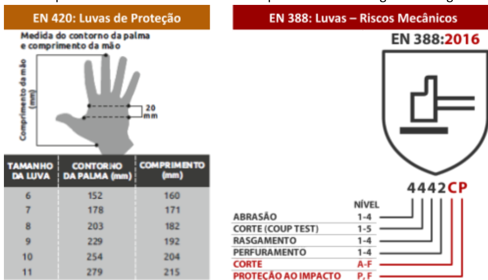
Figura 32 - Aspectos das normas EN 420 e EN 388 para Luvas do Triângulo de Resgate Ultra Safe
