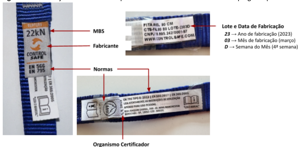
Figura 16 - Informações técnicas nas etiquetas dos Anéis de Fita Control Safe empregados pelo CBMDF
