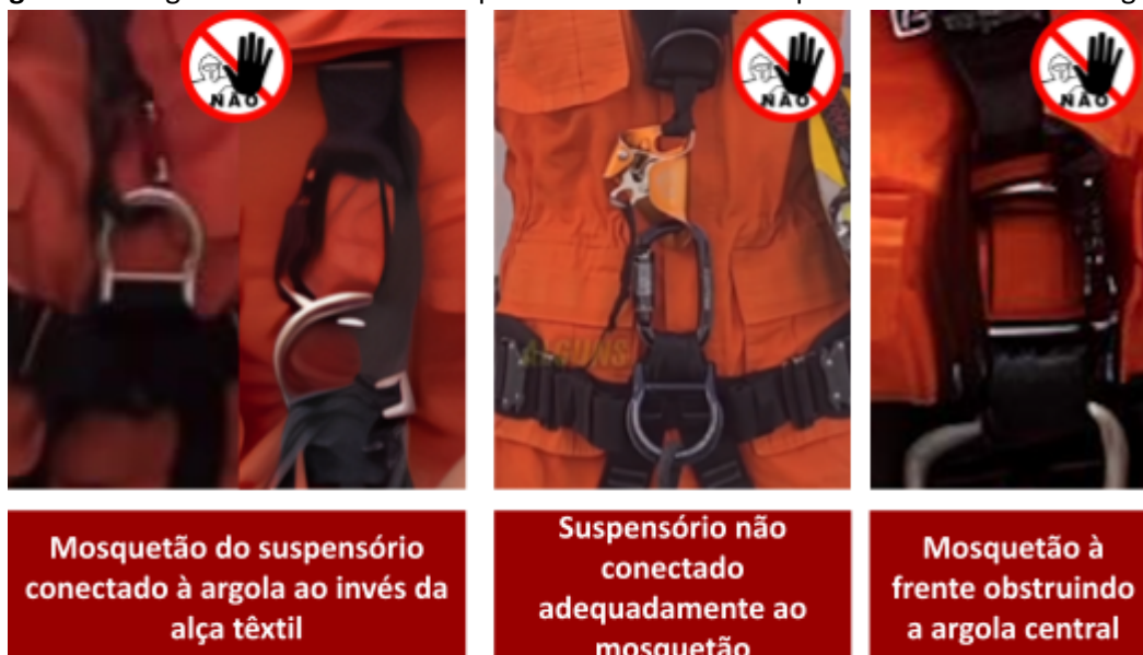
Figura 22 - Registros de formas inadequada de conexão do suspensório à cadeira de resgate
