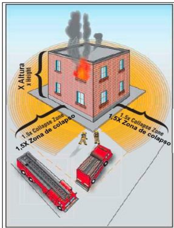
Figura 15 - Dimensionamento da zona de colapso estrutural.
