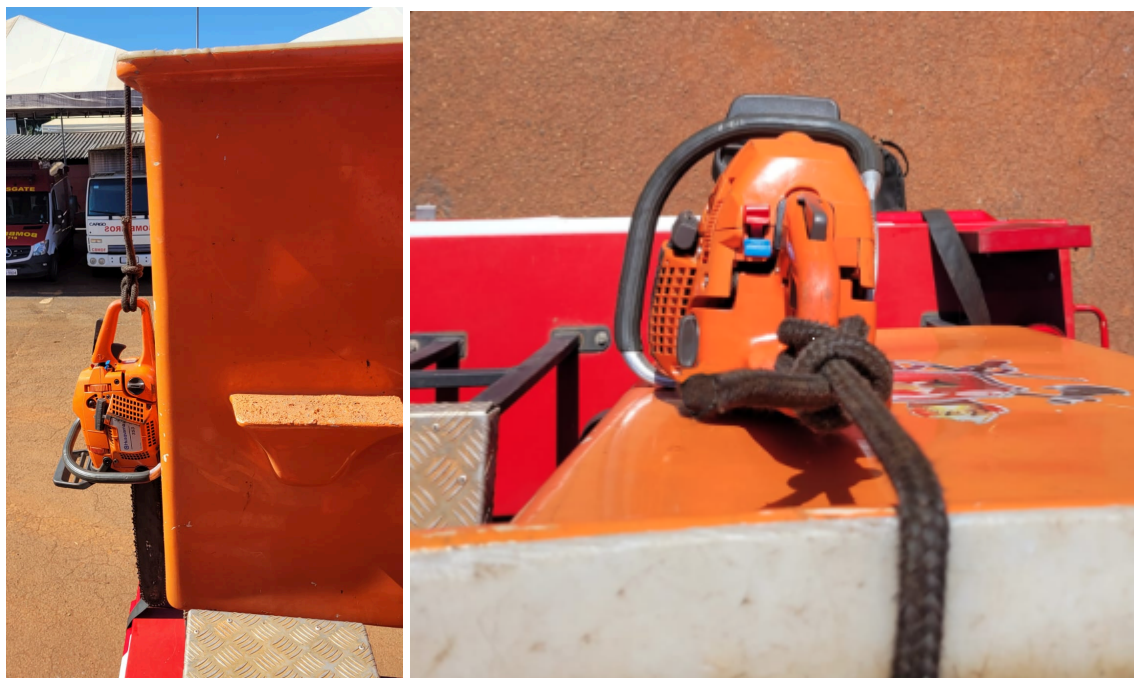
Figura 13 – Demonstração da motosserra amarrada no cesto
