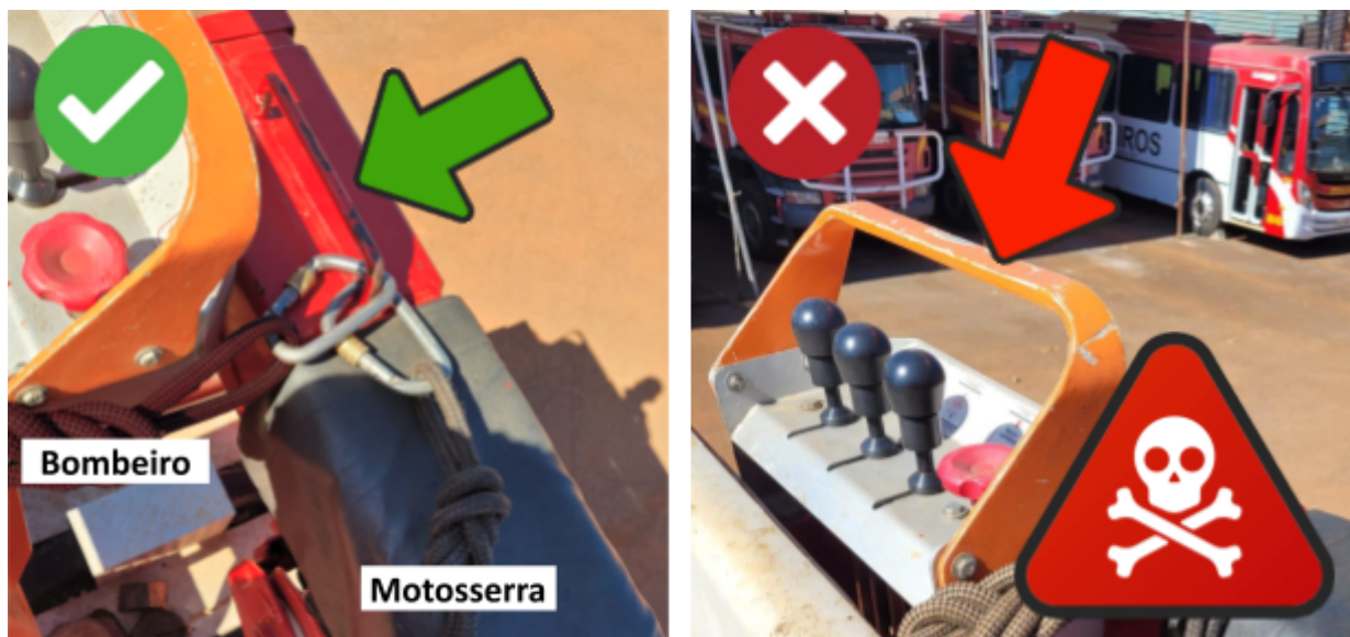
Figura 12 – Ancoragem do militar e da motosserra no cesto
