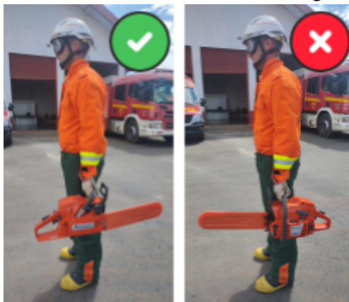
Figura 9 – Maneira correta e incorreta de carregar a motosserra
