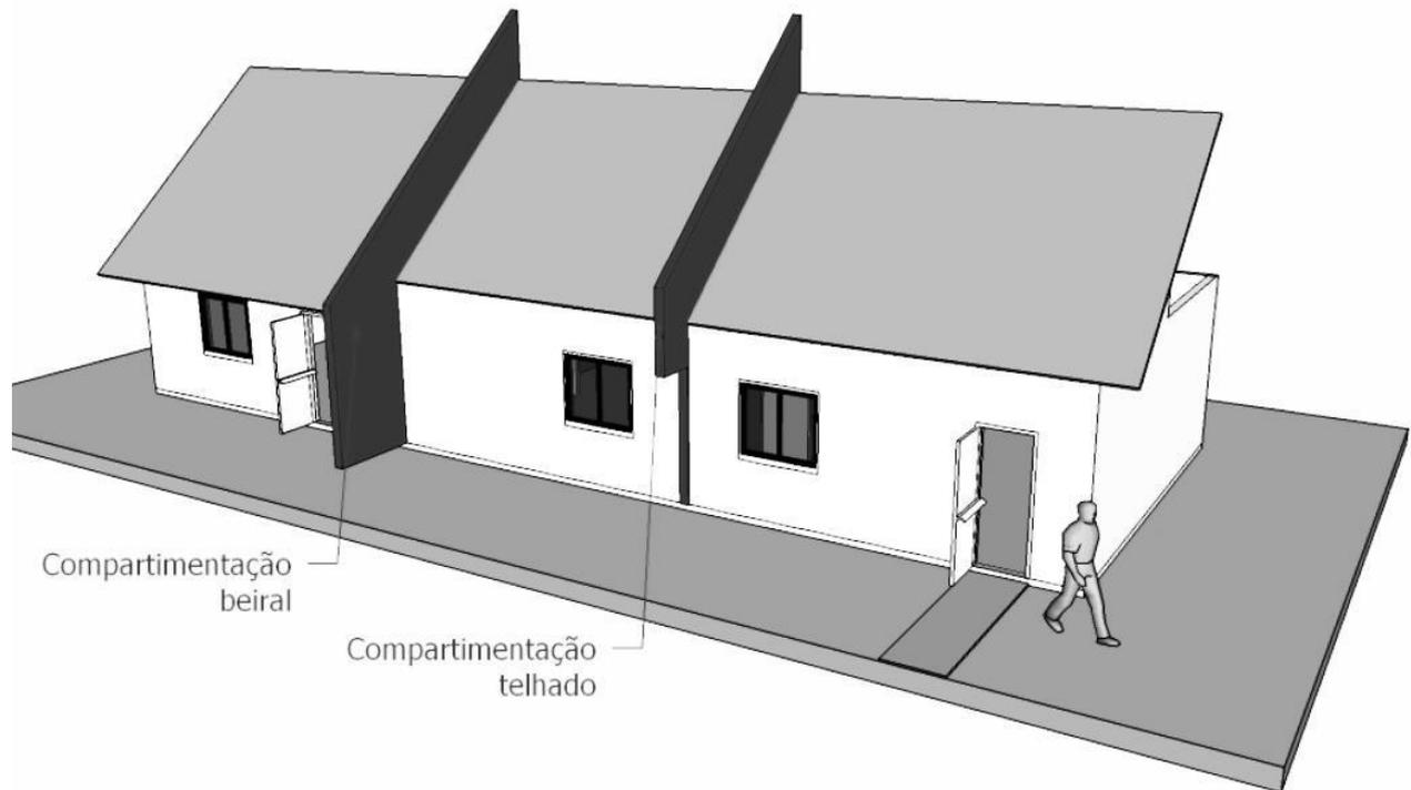
**(Nota 01)** Se as telhas combustíveis, translúcidas ou não, estiverem distanciadas pelo menos 2 m da parede de compartimentação, não há necessidade de se estender a parede 1 m acima do telhado (figura 1).
