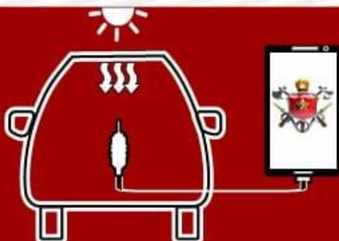
TESTES LABORATORIAIS DO CBMDF MOSTRARAM QUE O SISTEMA DE CARREGAMENTO ALCANÇOU QUASE 160°C, EM CONDIÇÕES NORMAIS DE FUNCIONAMENTO. QUANDO SIMULADO UM DEFEITO NO CABO USB, REGISTROU-SE 211°C EM POUCOS MINUTOS, O QUE PODE CAUSAR UM INCÊNDIO.
