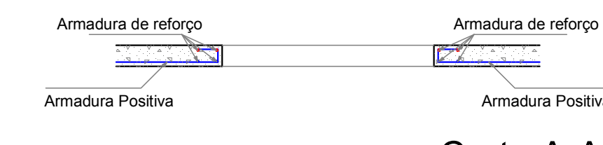
Corte A-A escala 1:25
