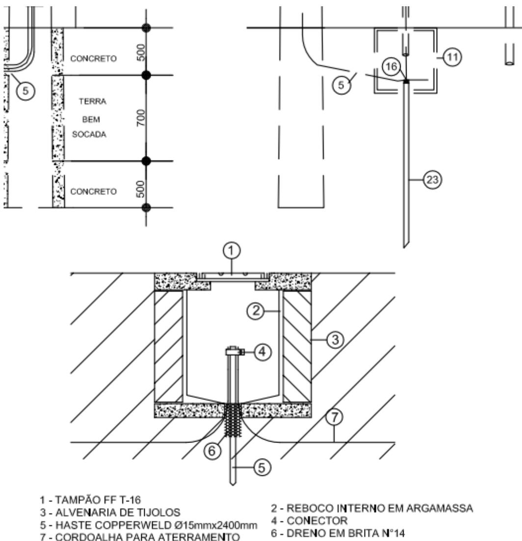
DETALHE - CAIXA DE INSPEÇÃO DE ATERRAMENTO
