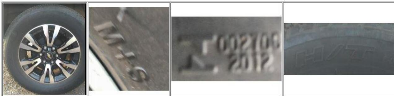
Pneu radial sem câmara (*tubeless tires*), com desenho da banda de rodagem do pneu para uso urbano, com possibilidade de trafegar em terrenos de lama (M+S). Uso nos eixos dianteiros e traseiros
