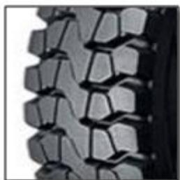
Pneu Radial com câmara, com desenho da banda de rodagem do pneu para tração e uso misto (M+S), tipo borrachudo, foto do pneu original da viatura
