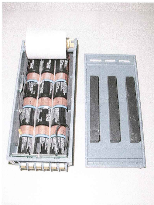
Foto 2: Bateria única lacrada do fabricante A violada para mostrar ser composta de várias baterias/pilhas de uso comum.
