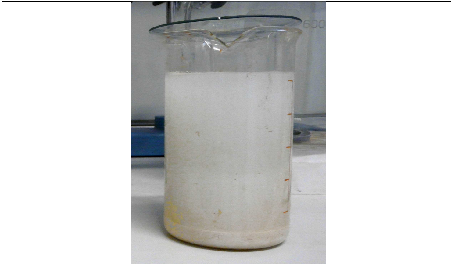
Figura 6. La precipitación de los sólidos durante el ensayo.
