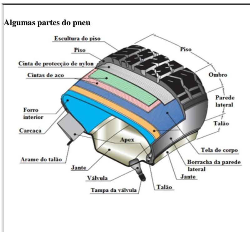
**4.13. Tipos de Construção de Pneus:**
