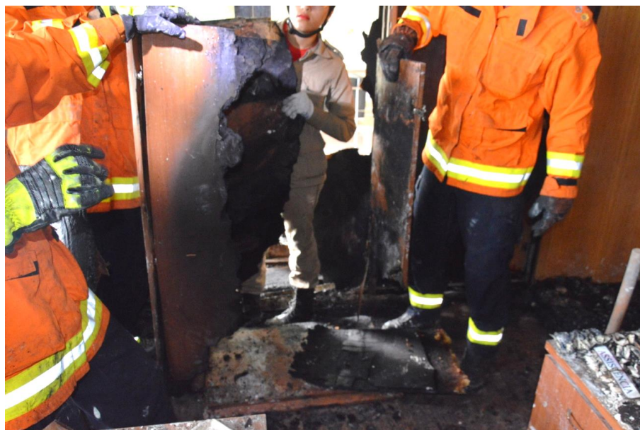
Figura 94 - Análise das marcas de queima em um armário de escritório revelam a intensidade do fogo no local
