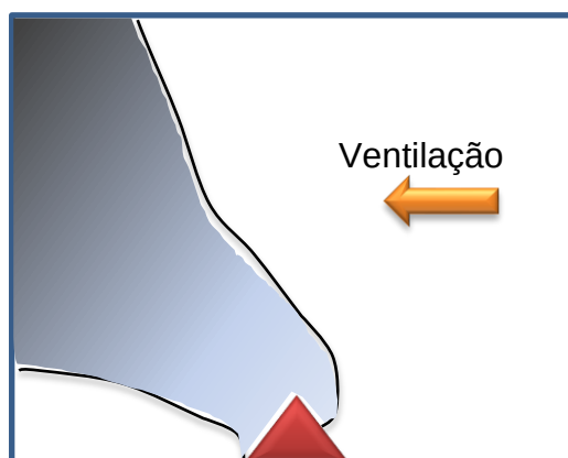
Figura 45 - Plumo de queima sob efeito da ventilação
