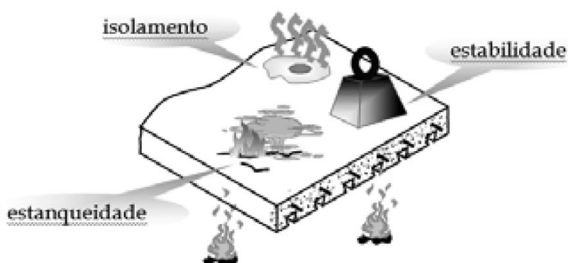
Figura 63 - Resistência ao fogo
