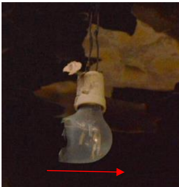
Figura 93 - Bulbo “estourado” de uma lâmpada. A seta indica o sentido de propagação do calor
