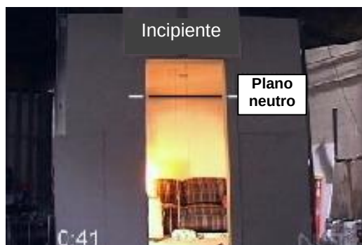
Figura 25 - Fase inicial de um incêndio.
