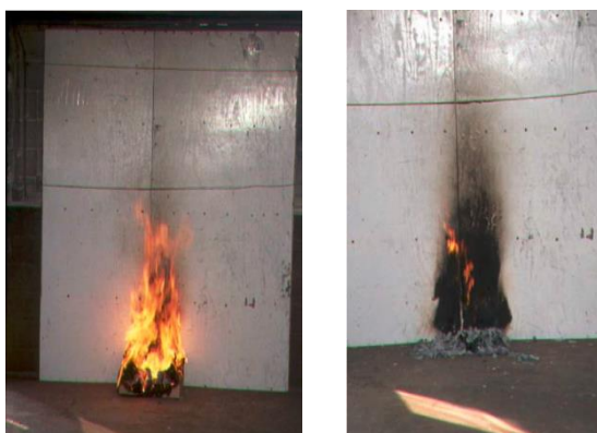
Figura 32 - Queima com pouca liberação de energia gerando um padrão V invertido ou triângulo
