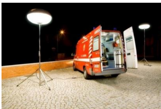
Figura 108 - Balão de Iluminação
