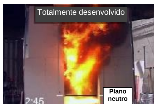
Figura 27 - Imagem de um incêndio totalmente desenvolvido
