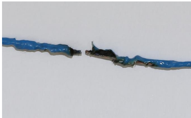
Figura 31 - Perda de propriedade física do fio condutor
