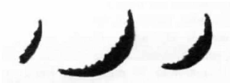
Figura 92 – Forma das partículas incandescentes, expelidas pelo escapamento de veículos pesados que utilizam motores de baixa compressão
