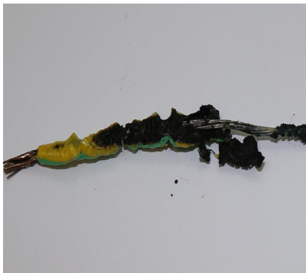
Figura 32 - Degradação do isolante do condutor elétrico
