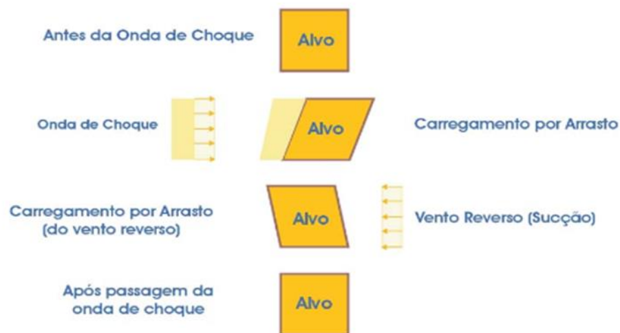
Figura 122 - Estrutura submetida a carregamento por arrasto
