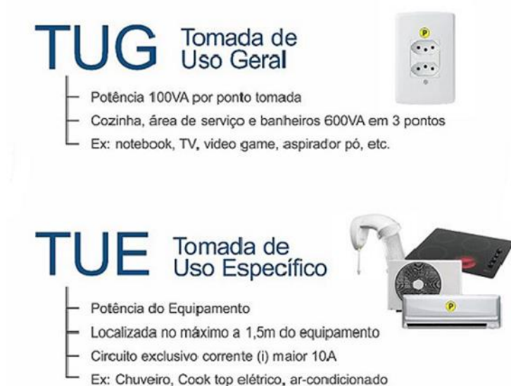
Figura 4 - Tipos de circuito elétrico de uma residência
