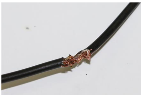
Figura 14 - Material isolante do condutor manteve sua integridade
