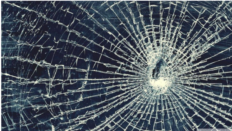
Figura 45 - Padrão de marcas de fratura no vidro por impacto mecânico: linhas radiais e concêntricas, a partir do ponto do impacto
