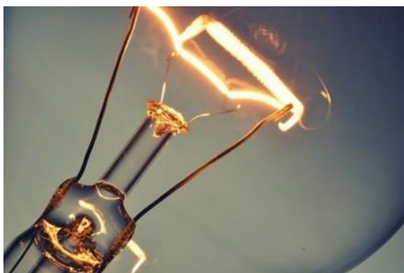
Figura 11 - Efeito Joule no filamento de uma lâmpada incandescente (aproximadamente 3.400°C)
