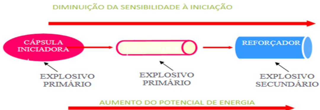
Figura 118 - Esquema de um trem explosivo
