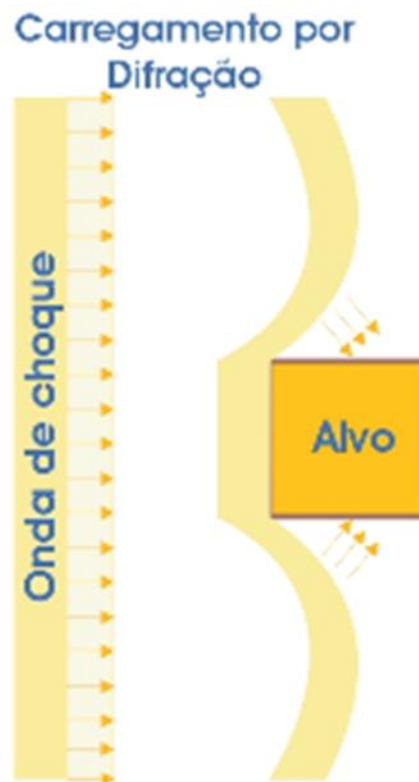
Figura 120 - Estrutura submetida a carregamento por difração
