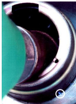
Figura 42 - Fagulha ocorrida durante o abastecimento, provocada pelo contato da boca de entrada do combustível com a lataria do veículo
