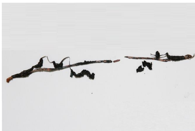
Figura 20 - Traço de fusão de sobrecarga com ruptura
