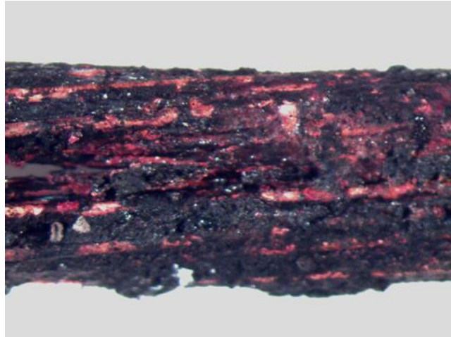
Figura 23 - Perda de propriedade física do fio condutor
