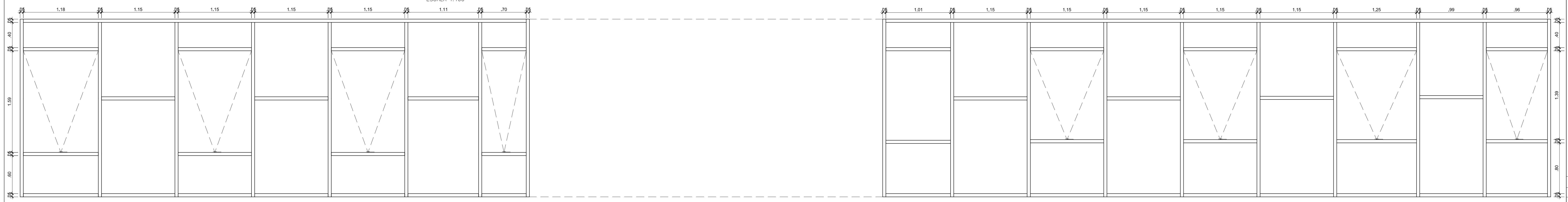
DETALHAMENTO ESQUADRA FACHADA FRONTAL VIDRO ASSENTADO EM CAIXILHOS FIXOS INDICAÇÃO DAS JANELAS MAXIM-AR ESCALA 1:25
