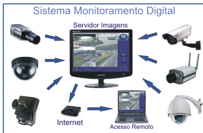
Figura 9: esquema didático de representação de um sistema de CFTV
