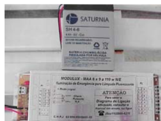
Figura 7.3 – Bateria interna e circuito com comutador, sensor e carregador
