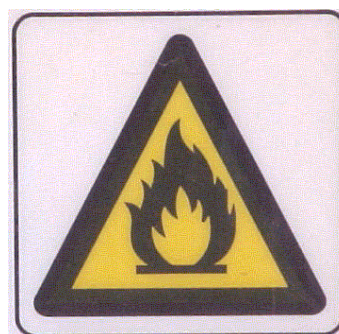
Figura 6.24 – Risco de incêndio
