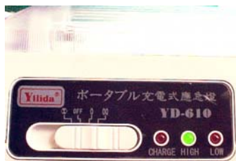
Figura 7.2 – Leds de Controle de Supervisão
