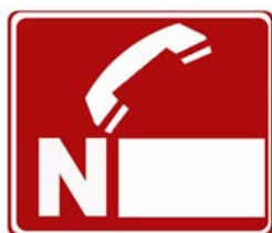
Figura 6.14 – Sinalização de brigada de incêndio
