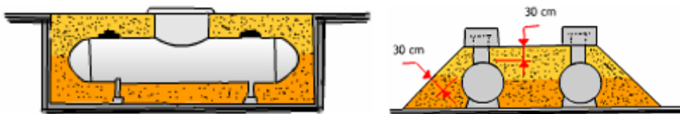
Figura 10.5 – centrais de GLP enterrada e aterrada.
