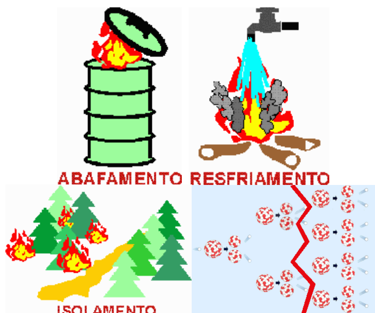
Figura 2.7 – Métodos de extinção do fogo. Fonte: CBMDF.
