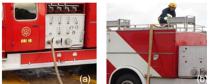
Figura 143 - Abastecimento de hidrante urbano utilizando a mangueira
