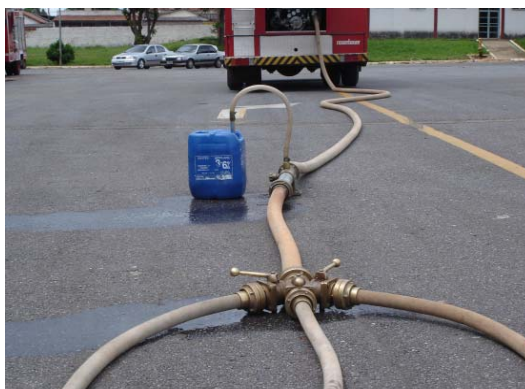
Figura 139 - Bomba armar utilizando espuma nas linhas
