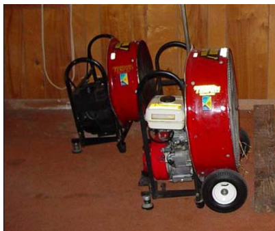
Figura 204 - Ventiladores de motor a explosão
