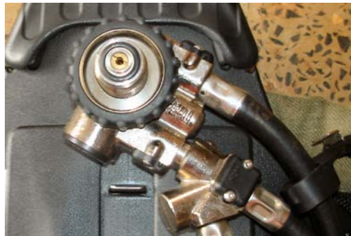
Figura 9 - Válvula redutora de pressão
