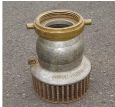
Figura 65 - Ralo com válvula de retenção
