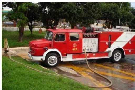
Figura 142 - Abastecimento de hidrante utilizando mangueira
