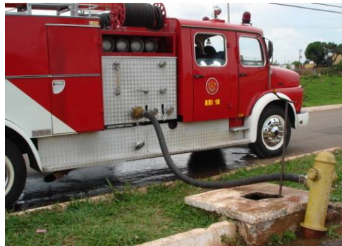
Figura 141 - Abastecimento de hidrante urbano utilizando o mangote
