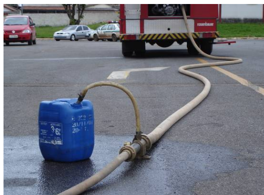
Figura 138 - Misturador entre linhas
