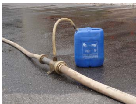
Figura 63 - Misturador entre linhas conectado às mangueiras e ao LGE
