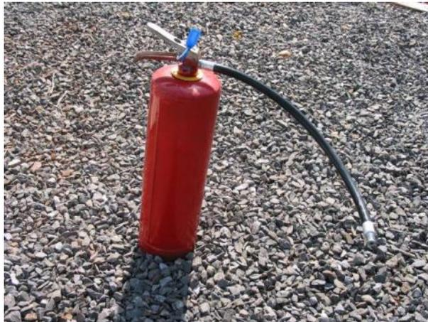
**Figura 11 – Aparelho extintor que pode ser de água pressurizada ou de pó para extinção de incêndio**
