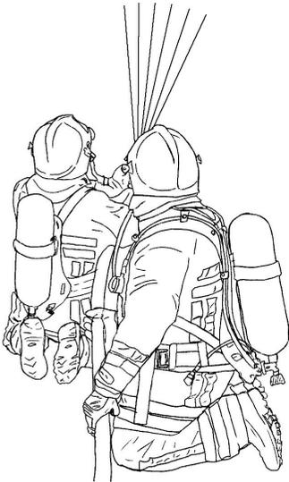
Abertura rápida e completa do esguicho, traço do gesto, depois fechamento. As três letras começam de cima e o esguicho se movimenta sempre na mesma velocidade. É o comprimento da letra que determina a duração total da abertura. Um só gesto, uma só vez. Em seguida, observação e finalização com jato mole (*painting*).
