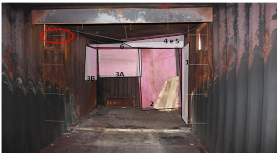
Figura 1 - Representação gráfica do posicionamento dos madeirites e dos sensores de temperatura.
