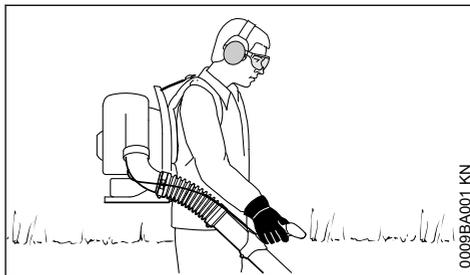
A máquina é levada nas costas. A mão direita conduz o tubo soprador no cabo de manejo.
