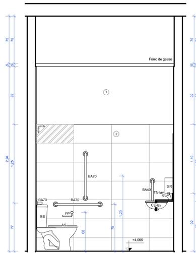
10 WC PCD-1º Pav- Seção DD
