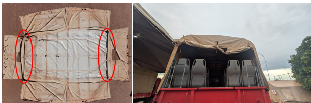
Figura 13 e 14: Posicionamento da costura da Safena/Abas frontal e posição da safena quando recolhida respectivamente.
