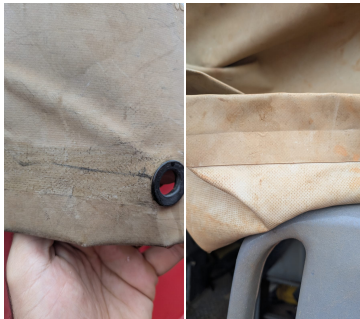
Figura 5 e 6: Borda da lona e acabamento com dobra e vulcanização, respectivamente.
