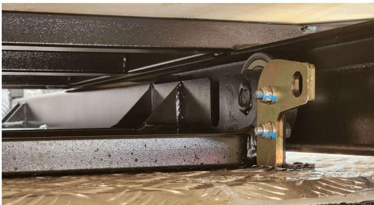
O suporte, construído em aço, será fixado no teto da capota especial de fibra, para instalação de abafadores de 3 metros e material de sapa de 2 metros, possuindo sistema de travamento de fácil manejo e acesso, que impeça o deslizamento e soltura dos equipamentos instalados. O suporte deverá possuir no mínimo 3 pontos de apoio no teto.
