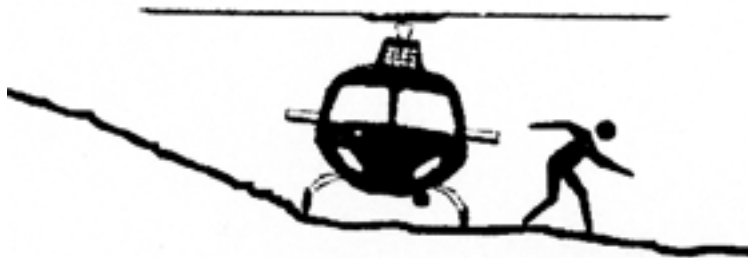
Figura 388: em terreno inclinado, ande pelo lado mais baixo.
