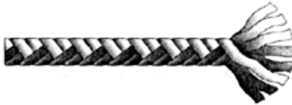
Figura 9: estrutura de uma corda trançada.
