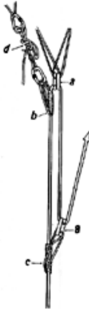
Figura 353: sistema com dois mosquetões.
