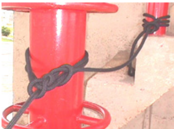
Figura 59: nó direito no ponto de fixação.
