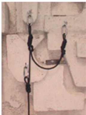
Figuras 463 e 464: ancoragem em linha
