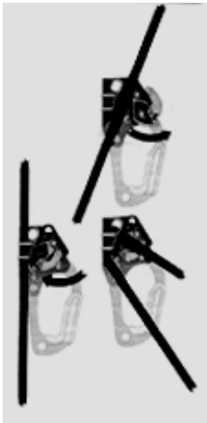
Figura 645, 646 e 647: introdução do mecanismo de autobloqueio na corda.
