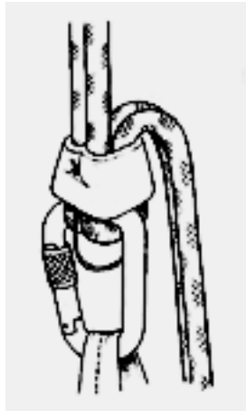
Figura 617: tubos de freio.
