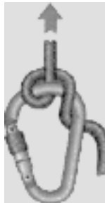
Figura 518: uso correto com o nó “mezzo barcaiolo”, nó dinâmico (nó UIAA).
