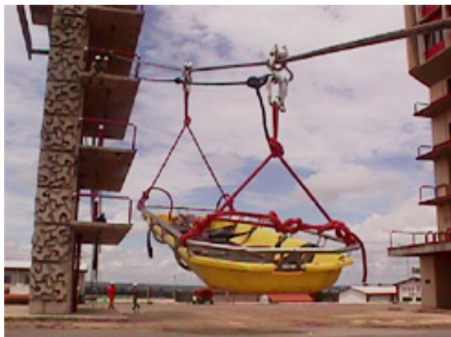
Figuras 251, 252 e 253: técnica de armação do sistema com o emprego do da maca, conjugada com o sistema de mosquetão ou roldanas.
