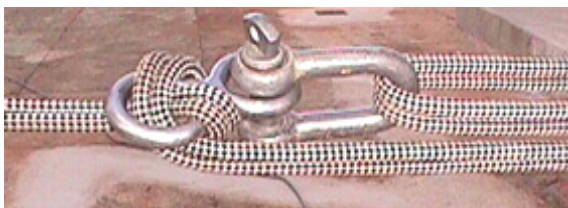
Figuras 62 e 63, respectivamente: tração com grampo e ou com mosquetões.
