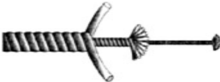
Figura 8: entrelaçamento interno de uma corda torcida
