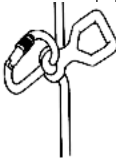
Figura 605: forma de emprego como placa de freio (dissipador).
