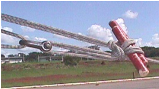
Figuras 62 e 63, respectivamente: tração com grampo e ou com mosquetões.
