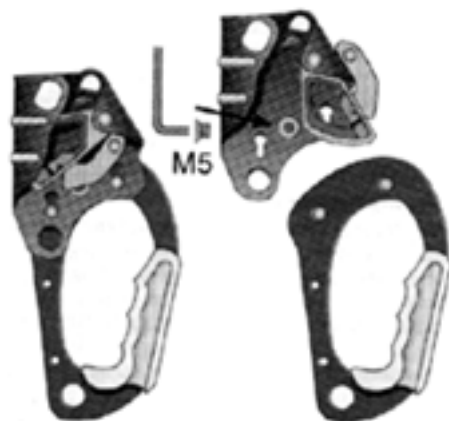
Figura 633, 634 e 635: mecanismo de autobloqueio com punho (podendo ser móvel ou não) com tamanho ideal para uma boa empunhadura, principalmente para o uso com luvas, ideal para alpinismo.
