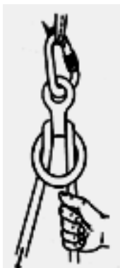
Figura 611: sistema básico de freio dinâmico, o qual requer maior atenção da pessoa responsável pela manutenção do freio.
