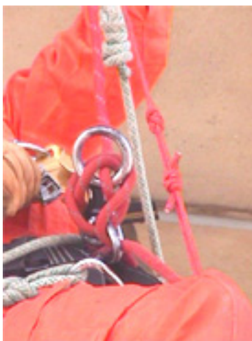
Figura 418: detalhe da amarração que permite a inversão.
