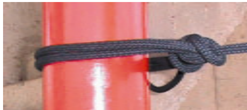
Figura 58: lingas de corda usadas para ancoragem.
