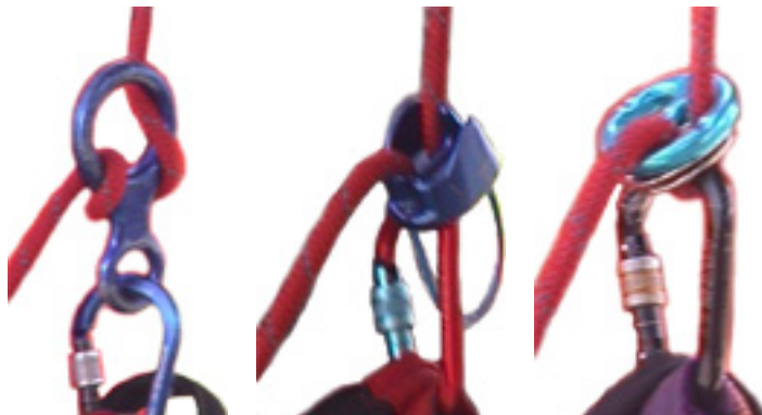
Figuras 588, 589 e 590, respectivamente: sistemas oito, ATC e com placa dinâmica.
