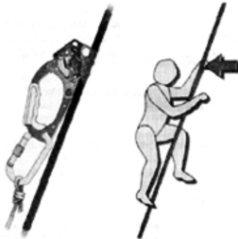
Figura 658 e 659: utilização de mecanismo de autobloqueio em cabo têxtil fixo.
