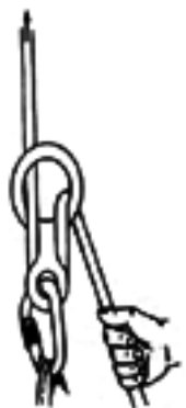
Figura 611: sistema básico de freio dinâmico, o qual requer maior atenção da pessoa responsável pela manutenção do freio.
