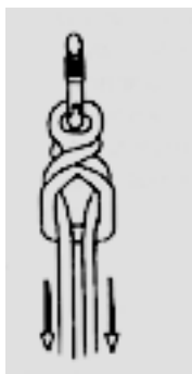
Figura 606: posição de autobloqueio, com o emprego do oito fixo.
