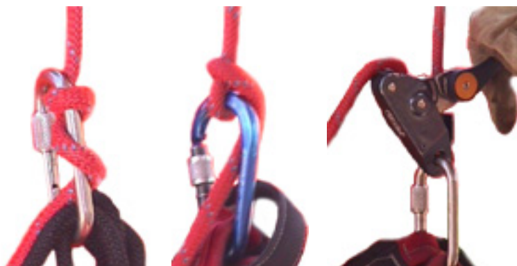
Figuras 591, 592 e 593, respectivamente: sistemas com mosquetão/técnica asiática (Japão), europeu, de autobloqueio.
