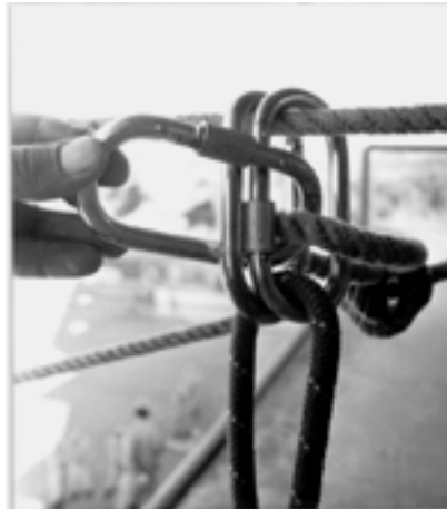
Figura 247: técnica de armação dos sistemas com o emprego do mosquetão.
