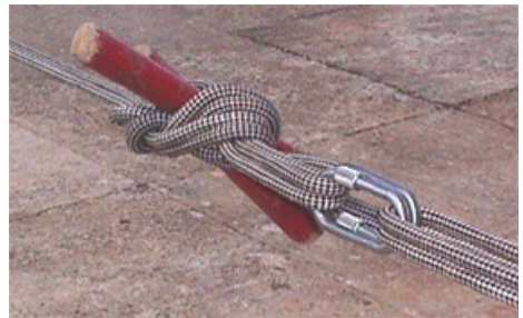
Figuras 62 e 63, respectivamente: tração com grampo e ou com mosquetões.
