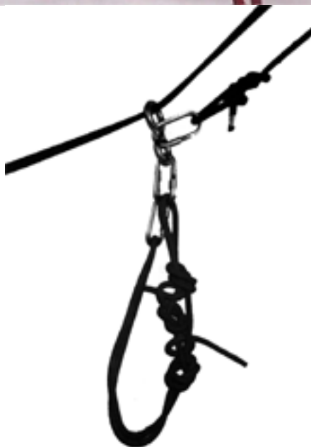
Figuras 249 e 250: técnica de armação dos sistemas com o emprego do aparelho oito.
