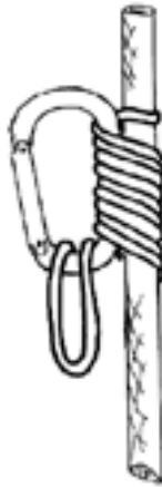
Figura 710: sistema autoblocante com mosquetão (bachimann).
