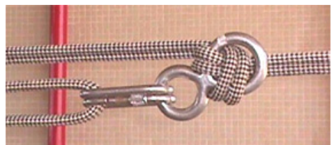
Figuras 62 e 63, respectivamente: tração com grampo e ou com mosquetões.
