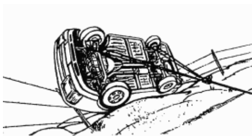
Figura 326: ancoragem em veículo tombado.
