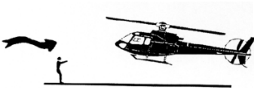
Figura 394: orientação é feita de costas para o vento.
