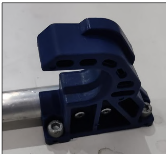
Figura 9 – Sistema de retenção dianteiro esquerdo após os ensaios
