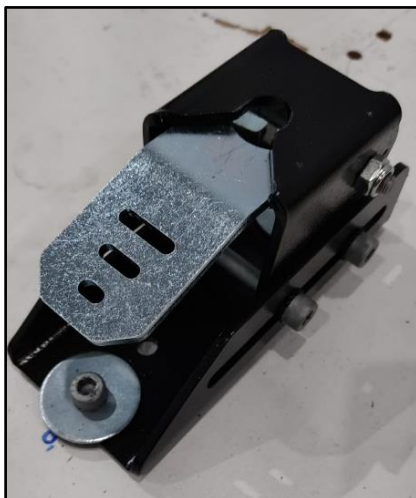
Figura 7 – Sistema de retenção traseiro após os ensaios
