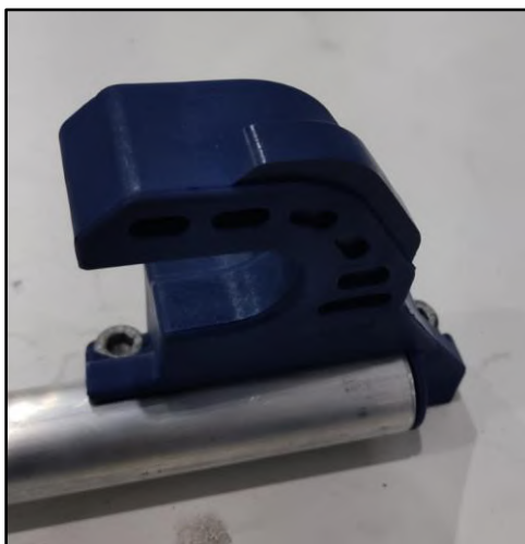
Figura 8 – Sistema de retenção dianteiro direito após os ensaios
