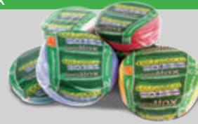
**Descrição:** Para tensões nominais até 450/750 V, formado por fios de cobre nu, eletrolítico, têmpera mole, encordoamento Classes 4 e 5 (flexíveis), isolado com polimérico, tipo poliolefinico não halogenado para 70 °C, com características de não propagação e auto-extinção do fogo e com baixa emissão de fumaça.
