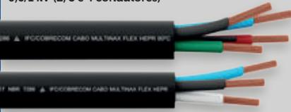
**Descrição:** Para tensões nominais até 0,6/1 kV, formado por fios de cobre nu, eletrolítico, têmpera mole, encordoamento Classes 4 e 5 (flexíveis), isolado com composto termofixo Etileno-propileno (HEPR), de alto módulo para 90 °C, veias torcidas entre si, formando o núcleo, e cobertura extrudada com policloreto de vinila (PVC), tipo ST2, antichama (BWF-B).
