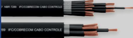
**Descrição:** Formado por fios de cobre nu, eletrolítico, têmpera mole, encordoamento Classes 4 e 5 (flexíveis), isolado com policloreto de vinila (PVC), tipo PVC/A para 70 °C, e cobertura com policloreto de vinila (PVC), tipo ST1 para 70 °C. Ambos os PVC's são antichama (BWF-B).
