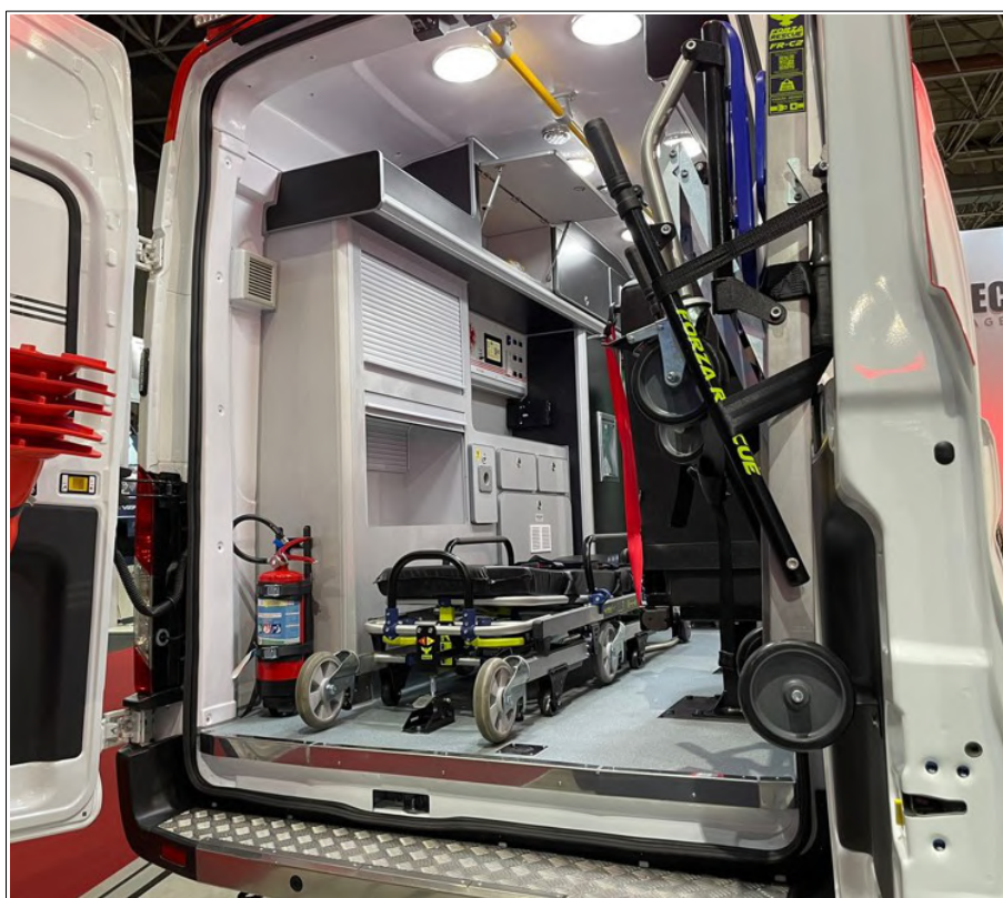
Figura 2.1 – Foto digital do conjunto da maca ancorada em uma ambulância (Fonte: Cliente).
