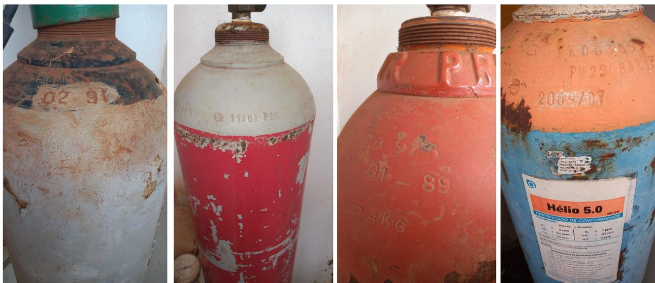
Imagens 1, 2, 3 e 4 (esquerda para direita) - Cilindro de alta pressão ar sintético (validade 02/1991), cilindro de alta pressão gás nitrogênio (validade 11/2007), cilindro de gás nitrogênio (validade 01/1989) e gás hélio (validade 07/2009).
