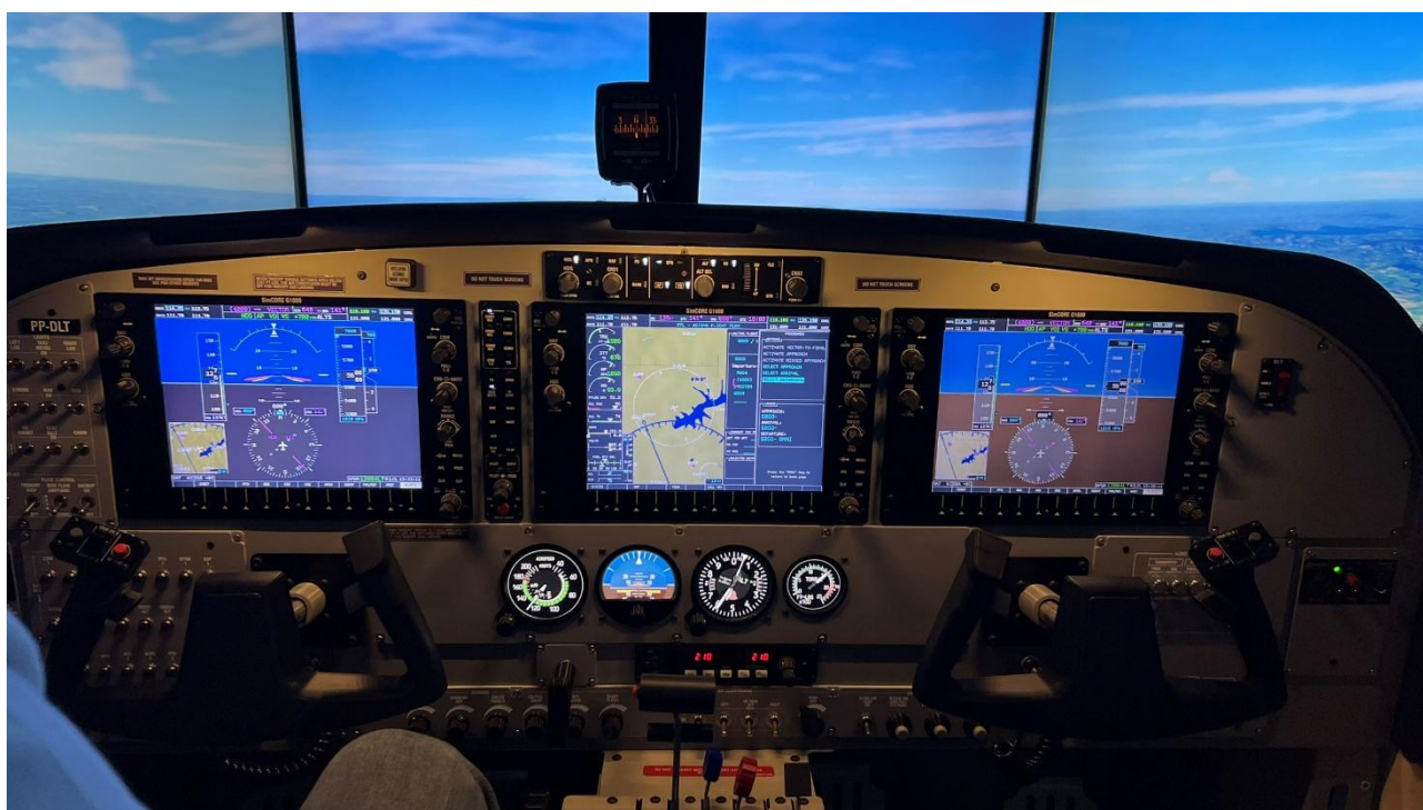
Imagem real do simulador: Cockpit com glasscockpit (Garmin G1000).
