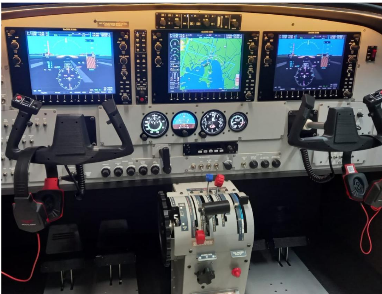
Imagens reais do simulador: Cockpit com glasscockpit (Garmin G1000).
