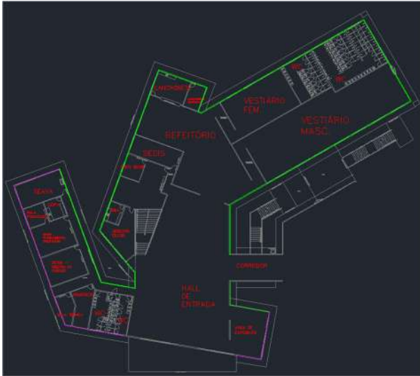
Figura 27: Reboco e chapisco fachada – Plata baixa Bloco B
