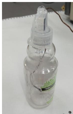
Figura 4: Montagem do frasco com álcool em gel, com o termopar instalado em seu interior.
