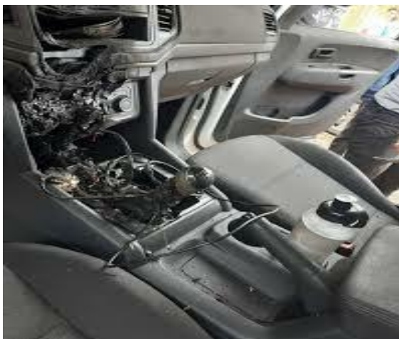
Figura 1: Incêndio em veículo no DF com suspeita de ter sido causado por álcool em gel
