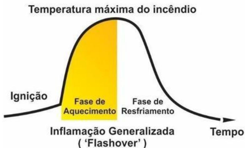
Figura 3 - Curva temperatura – tempo de um incêndio
