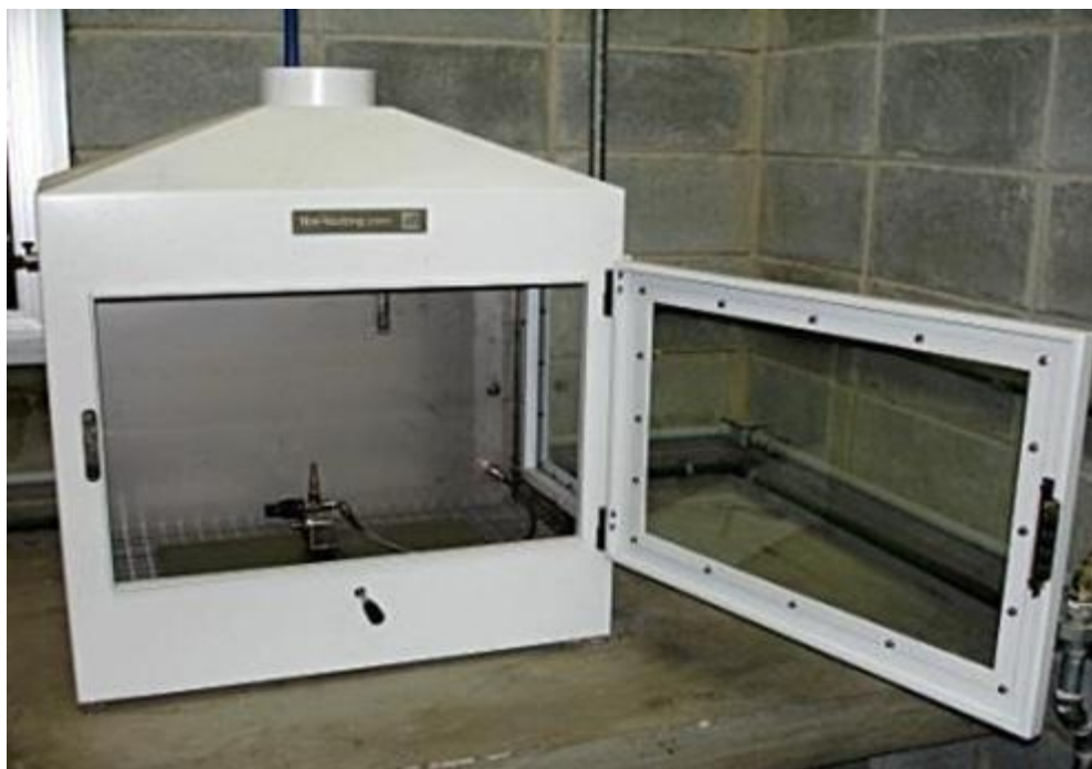
Figura 14 - Determinação da ignitabilidade dos materiais
