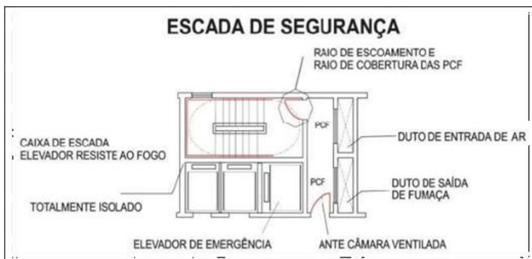
Figura 16 - Escada e elevador à prova de fumaça
