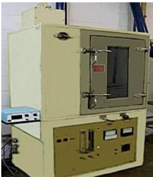
Figura 11 - Câmara de densidade óptica fechada
